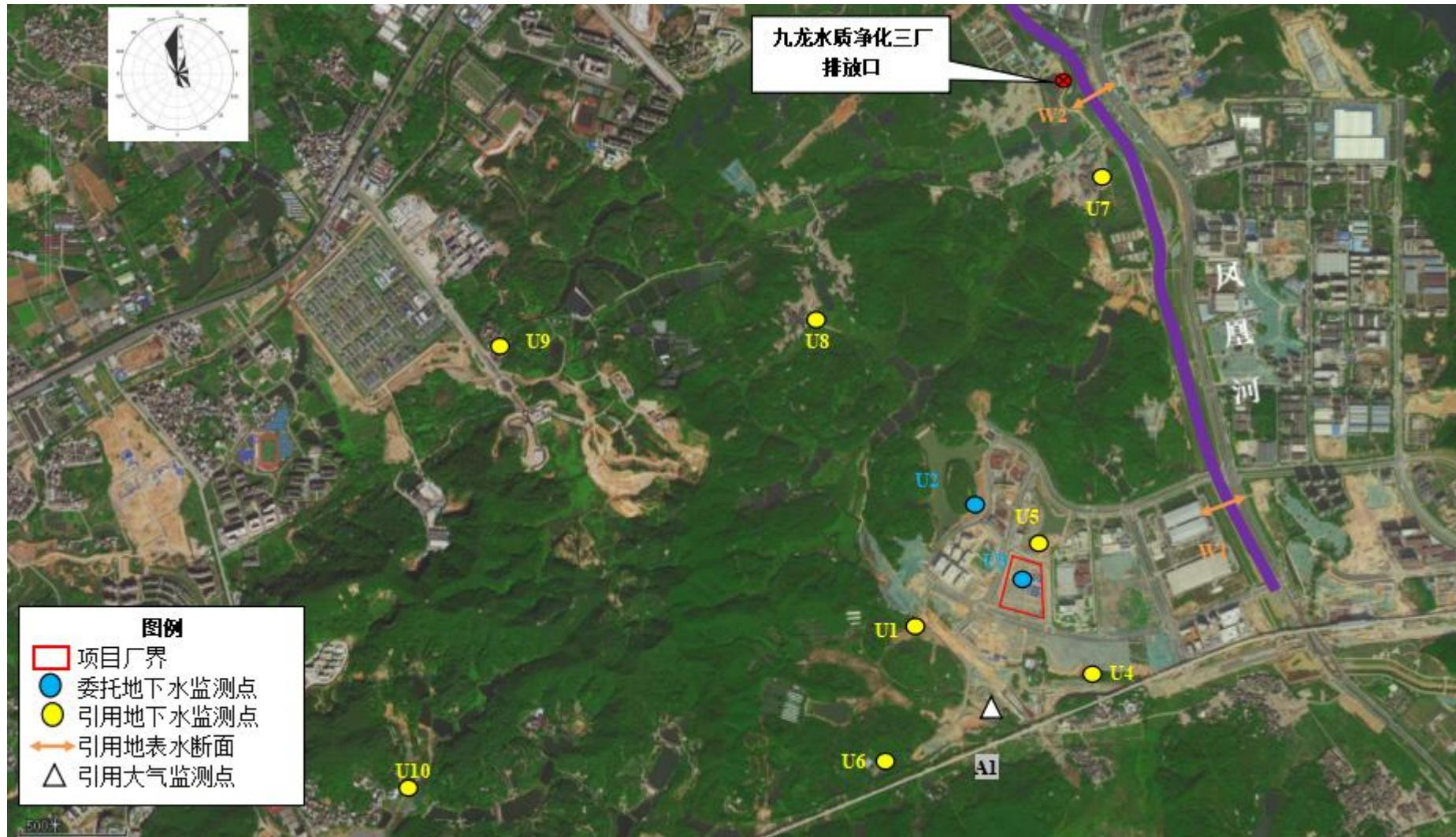
图5.4-1 地下水、大气、地表水监测点位图
