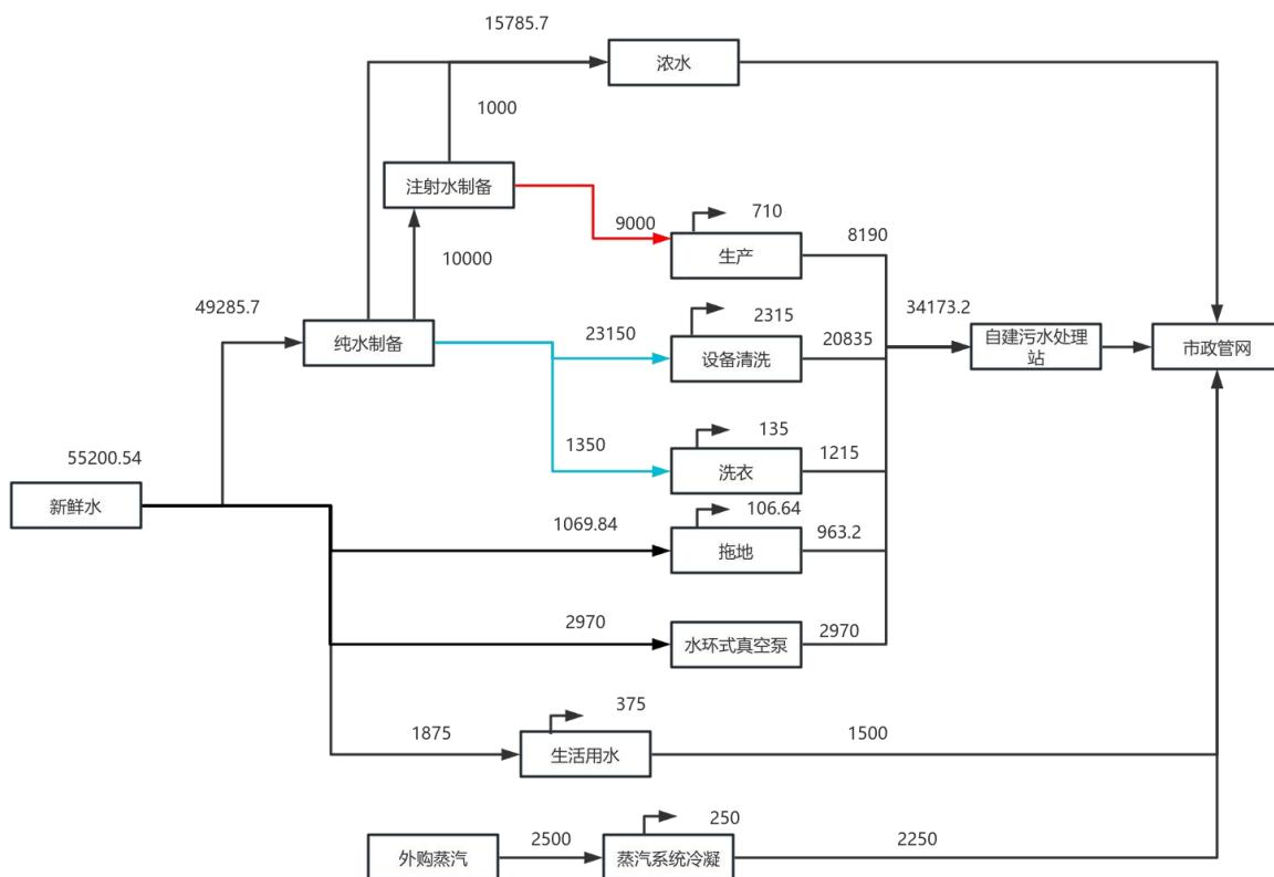
图4.2-9a 项目水平衡图 单位: t/a
