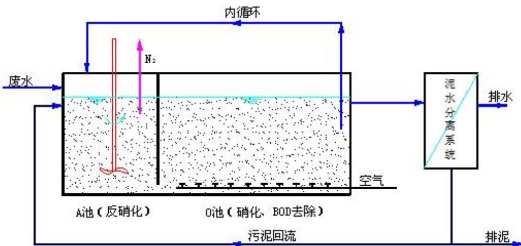
图 7.2-2a A/O 工艺流程示意图
