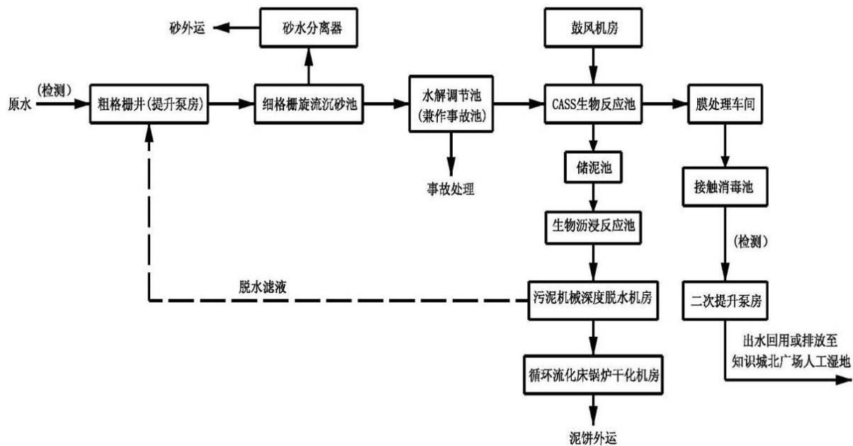
图7.2-3 九龙水质净化三厂污水处理工艺
