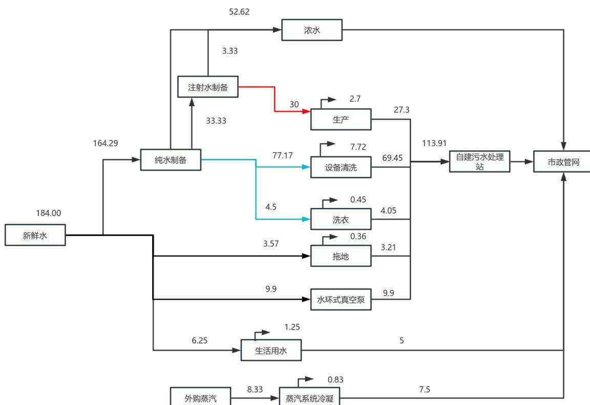
图4.2-9b 项目水平衡图 单位: t/d
