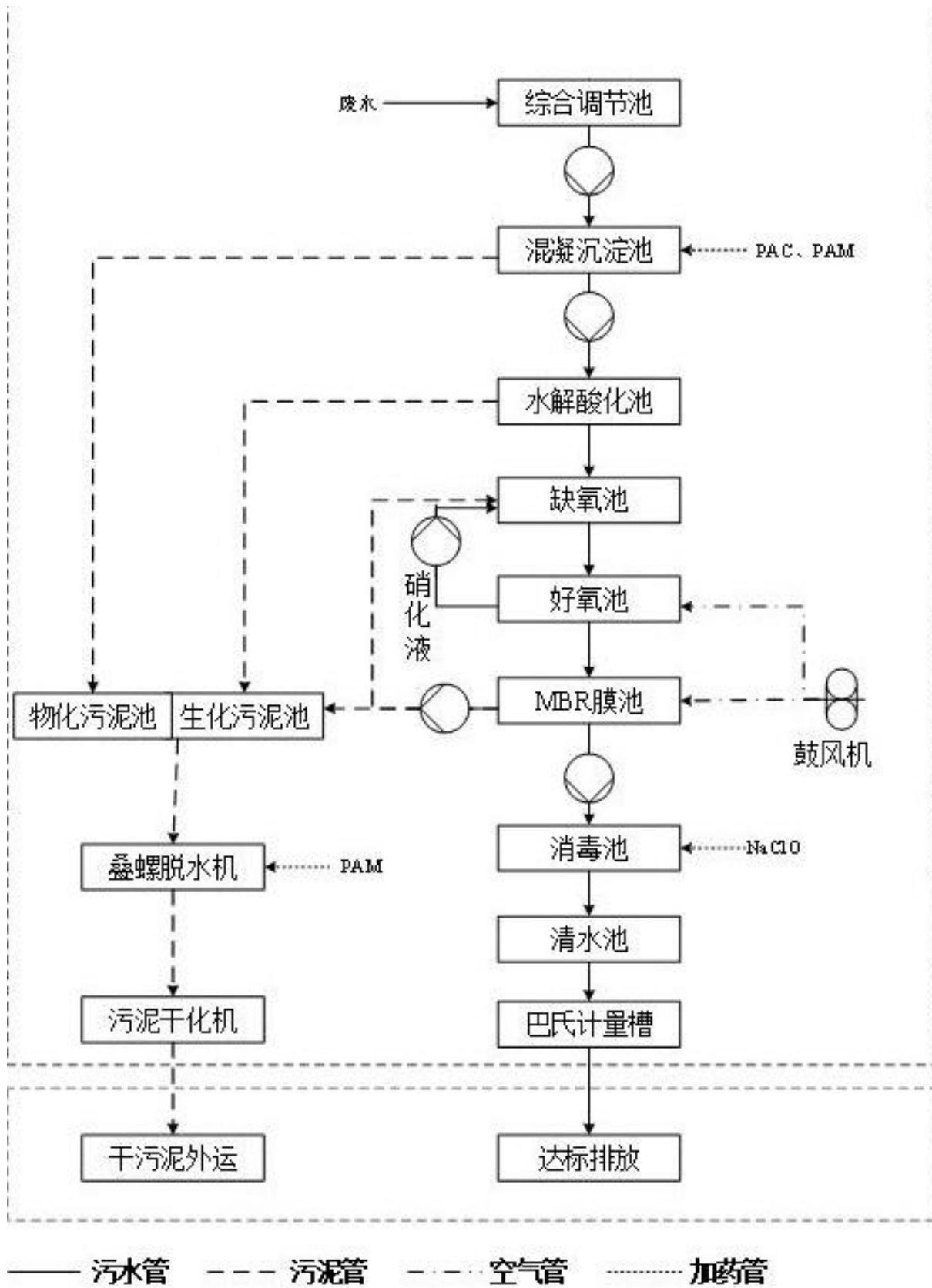
图7.2-1 项目污水处理工艺流程图
