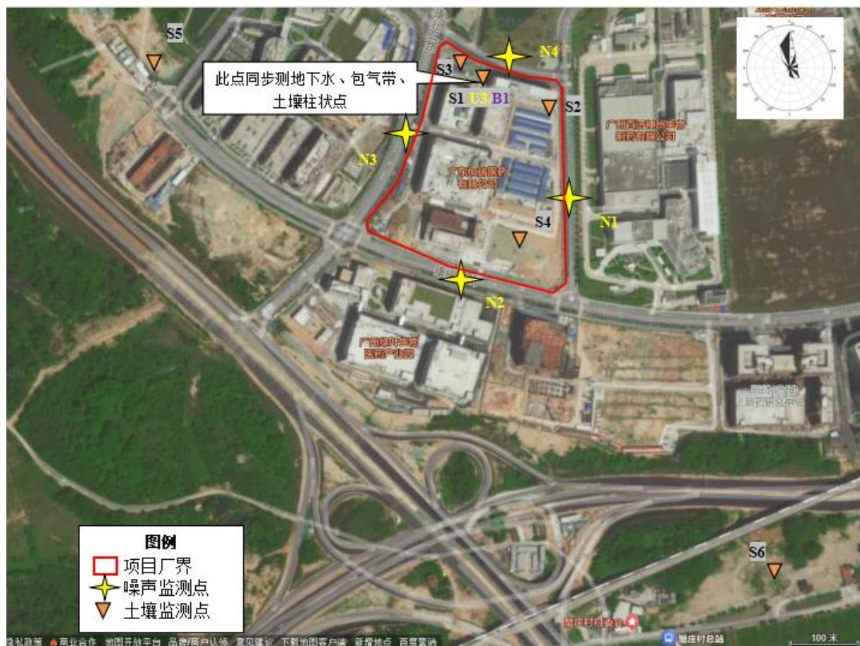
图 5.7-1 项目土壤、噪声、包气带监测点位图
